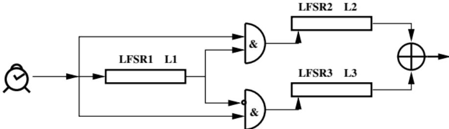
Podľa výstupu LFSR1 sa posúva práve jeden z generátorov LFSR2, LFSR3.
